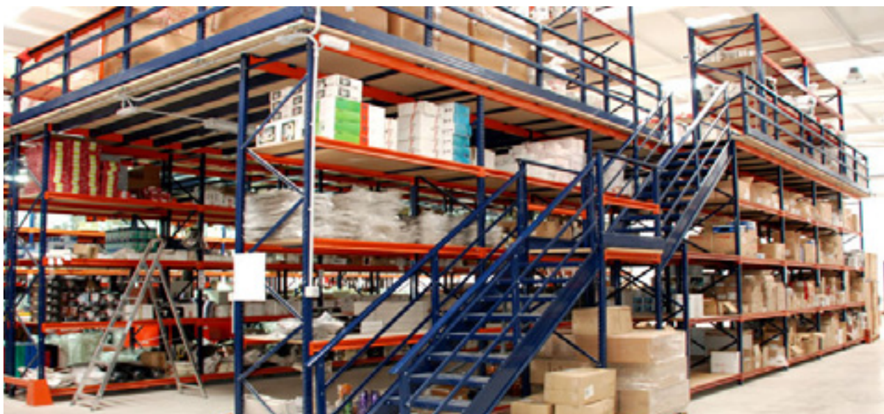
Rayonnage avec allées de circulation en passerelle.
